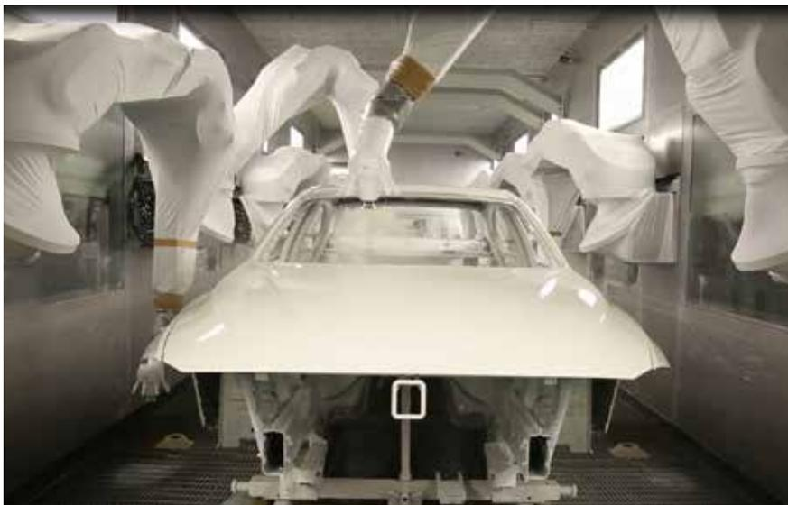
上圖：巴斯夫 CathoGuard® 800 電著塗料是全球領先的電著塗料技術，具有環保、節能、高穿透性、高防腐、表面平整度高等優異性能。
